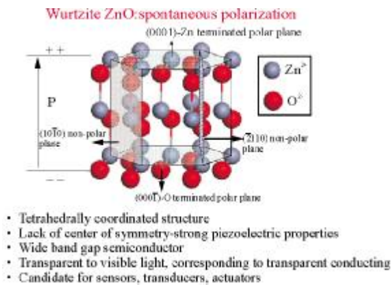
图1 ZnO 纤锌矿原子结构和极性面的形成
